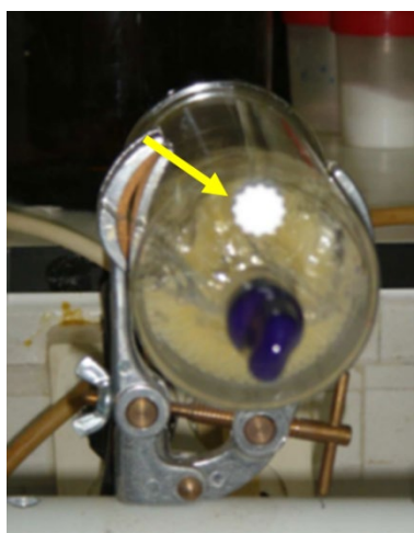
Figura 5. Vista frontal de la cápsula Envirocheck® HV en posición horizontal con la válvula de purga blanca (identificada con una flecha amarilla) en la posición horaria de 12 h. Fuente: cortesía Marisa Camaró Sala
