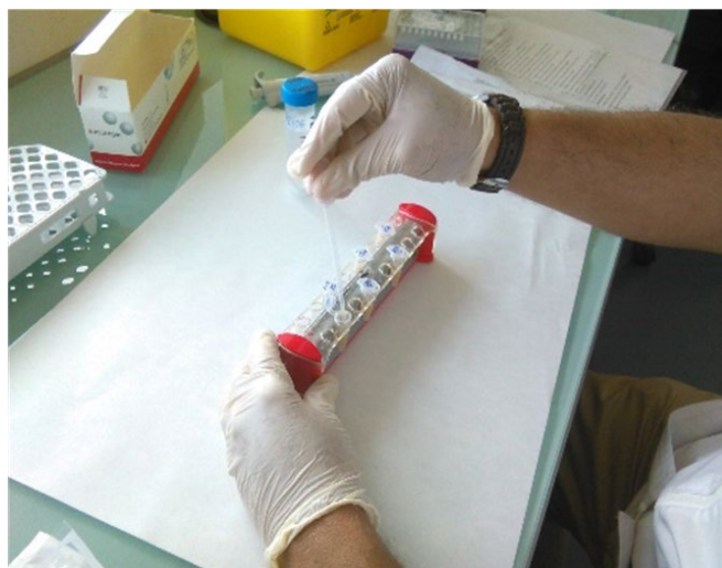
Figura 9. Transferencia de las partículas magnéticas aisladas en el concentrador Dynal MPC-1 a viales de 1,5 mL para su posterior lavado en la gradilla magnética Dynal MPC-S. Fuente: cortesía Marisa Camaró Sala
