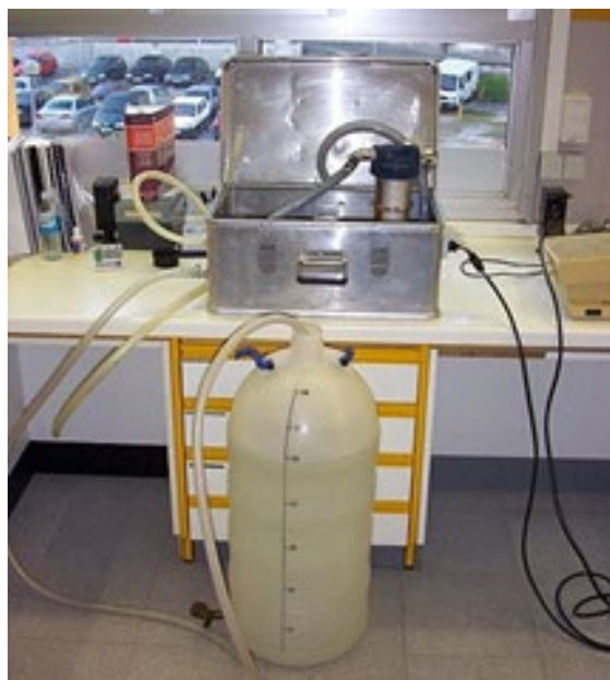
Figura 4. Filtración en el laboratorio de una muestra de agua transportada en un bidón de 50 litros. Fuente: cortesía David Carmena
