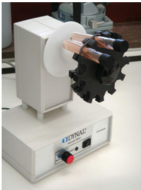
Figura 7. Separación inmunomagnética en tubos de lado plano incubados en un rotor tipo noria. Fuente: cortesía Marisa Camaró Sala
