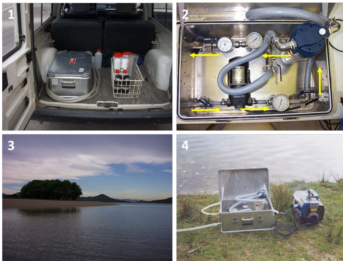
Figura 3. Panel 1. Equipo estándar para la filtración in situ de muestras de agua. Panel 2. Vista superior de la maleta portátil incluyendo manguera de entrada al circuito con llave para el control de flujo, bomba peristáltica, manómetro 1, manguera de entrada al portafiltros, manguera de salida del portafiltros, manómetro 2, caudalímetro y manguera de salida del sistema. Las flechas amarillas indican el flujo del agua a través del sistema. Panel 3. Punto de muestreo típico de aguas superficiales. Panel 4. Equipo de muestreo operando en condiciones de campo. Fuente: cortesía David Carmena
