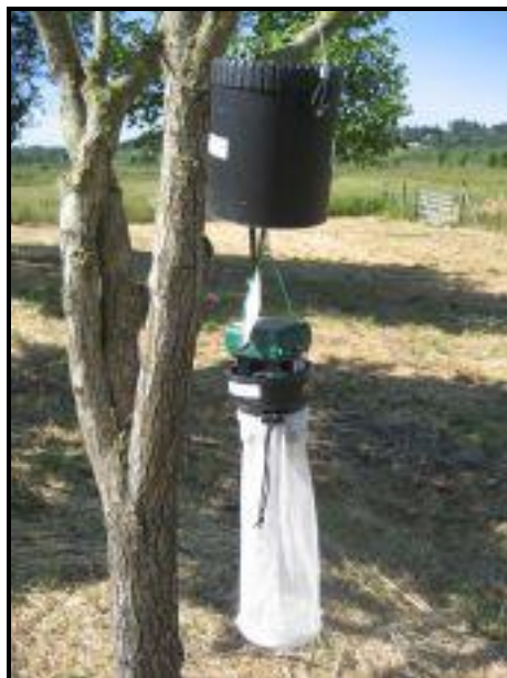
Figura 4. Trampa EVS de luz blanca con aporte de CO 2
